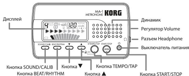
К разъему Headphones можно подключить наушники со стерео миниджеком (3.5 мм). При этом встроенный динамик отключается. Громкость в динамике и в наушниках устанавливается регулятором Volume.
